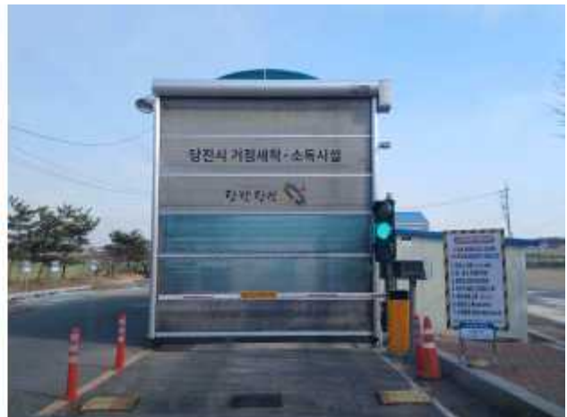
차단바, 빨간신호등, 정지시간표시로 앞차 소독중 / 차량 출차시 녹색신호등 바뀌고 차단바 올라감.
